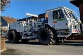
3D-seismische Messungen im Umfeld der Schachtanlage Asse II
